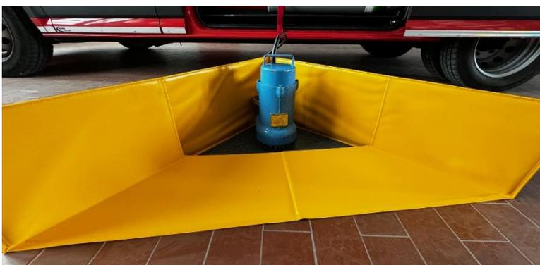
Der "**Wasserschluckler**" ist ein künstlicher Pumpensumpf und wird mit der kleinen Tauchpumpe vom KLAF und einem Wasserschieber betrieben.
